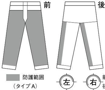
防護ズボンは、チェーンソーが布地の裏面に接触した時、防護繊維が引き出されスプロケットに絡みつくことで瞬時にソーチェーンの回転を停止させる機能を持ちます。防護材は左記に示す灰色前の部分をカバーして
